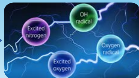
Los electrones chocan y se combinan con el nitrógeno y el oxígeno del aire para formar cuatro tipos de elementos en descomposición con poder de descomposición.
